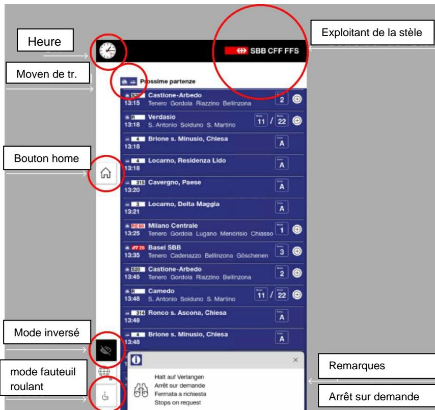
Fig. 279: positionnement des éléments de navigation et des éléments secondaires dans la vue des prochains départs
